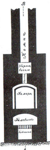
Мал. 50. Муфель для палення майолики. Поперечний розріз
