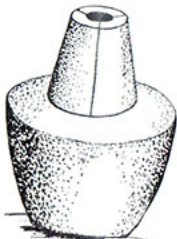
Мал. 23. Вигляд скляної гіпсової форми (як трюх частин) у кожці
