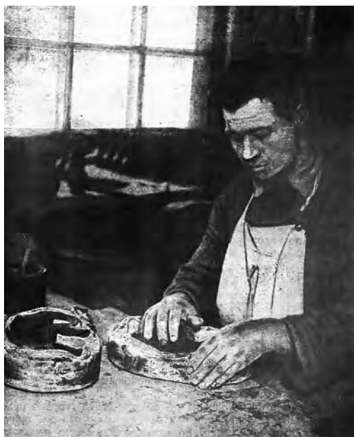
✿ Наліплювання декоративного елемента (квітка) на поверхню вази. Макарово-ярівська керамічна кустарно-промислова школа (?). Майстри: Михайло Кирячок – (?), 1, невідомий – 2. Макарів Яр, Луганщина (?). 1930 – початок 1931 (?). Автор фото невідомий. Репринти [143, с.45, рис.32, с.47, рис.38]
