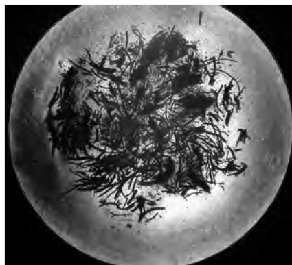
Рис.23. Реакция волокна (текстиль из Гришковки) с \text{H}_2\text{SO}_4 /конц./ (микроскопия в проходящем свете; увеличено в 32 раза; кислота не реагирует ни с волокном, ни с красителем). Фото Татьяны Крупы
