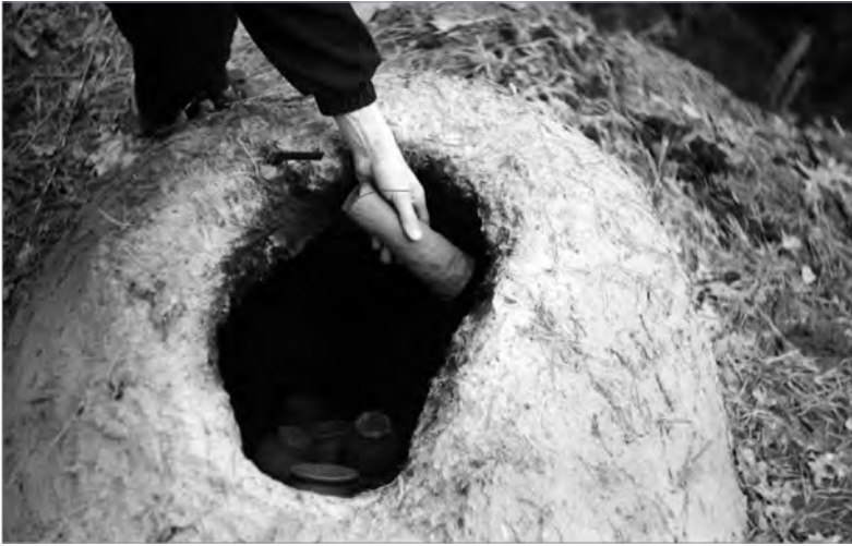
Мал.4. Горно на етапі замазування завантажувального отвору. Ходосівка, Київщина. 2003. Фото Андрія Петраускаса. Публікується вперше
